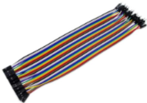
**Figura 5. Jumpers. Fonte: Robo-core.**
