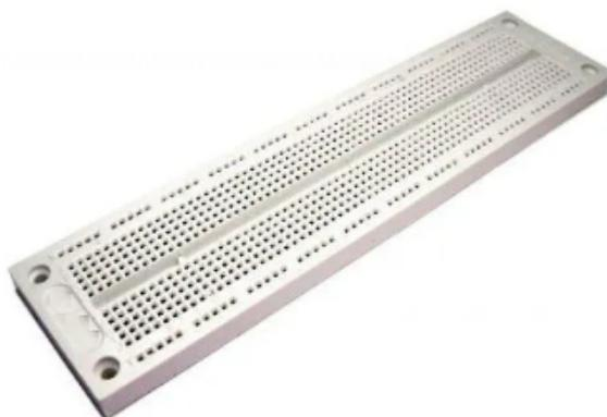
**Figura 6. Protoboard. Fonte: Casa da robótica.**
